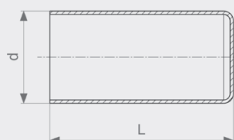
Prestabo-korek dlugi - stal niestopowa, ocynkowana nr wzoru 1157.1
