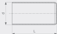
Prestabo XL-korek dlugi - stal niestopowa, ocynkowana nr wzoru 1157.1XL
